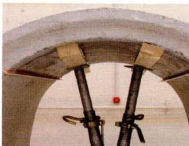
Figure 7 : Placage des lamelles
