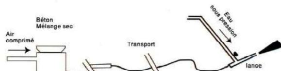
Figure 4 : Projection par voie sèche (sans prémouillage)
